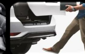
Compuerta trasera con sensor de apertura
